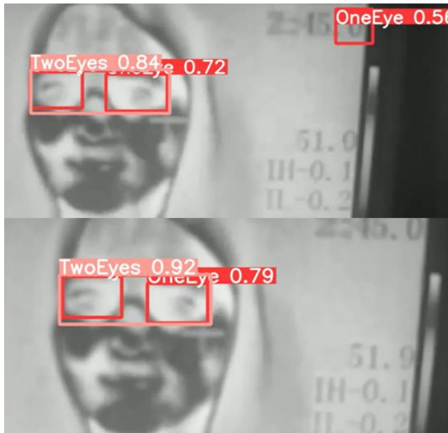
Figure 5. La même scène vidéo avec une fausse détection de la classe "OneEye" par YOLOv5n (partie supérieure) et sans fausse détection avec YOLOv5s (partie inférieure), toutes deux avec des scores de confiance.
