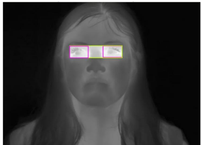
Figure 3. Exemple d'image étiquetée et de fichier texte d'étiquettes correspondant, case rose : classe d'un œil, case jaune : classe de deux yeux ; nc = numéro de classe.
